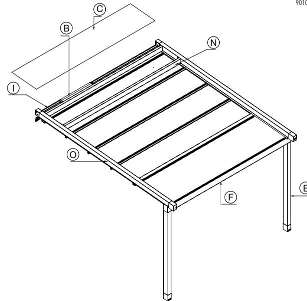
Struttura ombreggiante in alluminio con tenda richiudibile ad impacchettamento, formata da un telo [teso quando aperta] fissato ad un sistema di traversi, carrelli e guide che ne permettono lo scorrimento orizzontale. Resistenza al vento garantita fino alla classe 3 secondo la UNI EN 13561. Su richiesta è possibile installare il sistema antigoccia per la protezione dalla pioggia. Non si garantisce la tenuta al carico di neve.
