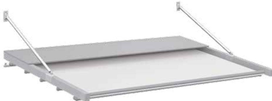
Struttura a pensilina in alluminio con tenda richiudibile ad impacchettamento formata da un telo fissato ad un sistema di traversi e guide che ne permettono lo scorrimento orizzontale. La struttura poggia su due staffe laterali che fungono da spinta e stabilizzano la struttura stessa. Resistenza al vento garantita fino alla classe 3 secondo la UNI EN 13561. La formazione di condensa sul telo non è da considerarsi difetto, si tratta di un fenomeno naturale.
