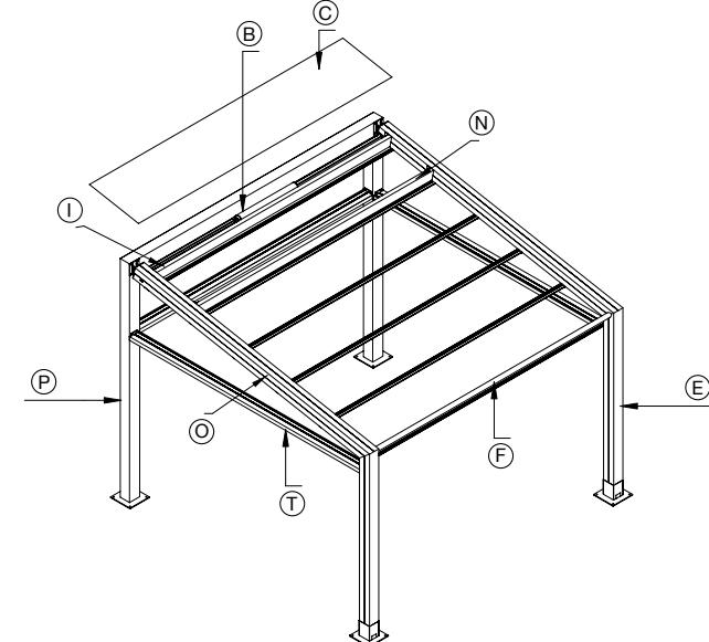
Struttura ombreggiante autoportante in alluminio con tenda richiudibile ad impacchettamento, formata da un telo (teso quando aperta) fissato ad un sistema di traversi, carrelli e guide che ne permettono lo scorrimento orizzontale. Resistenza al vento garantita fino alla classe 3 secondo la UNI EN 13561. Su richiesta è possibile installare il sistema antigoccia per la protezione dalla pioggia. Non si garantisce la tenuta al carico di neve.
